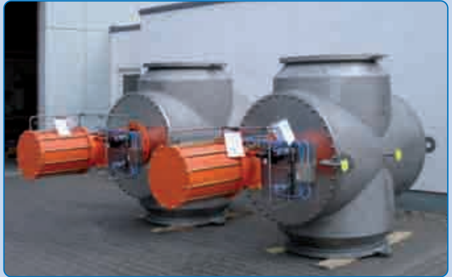
Proyecto: RIL India. Válvulas de 3 vías de 38"
